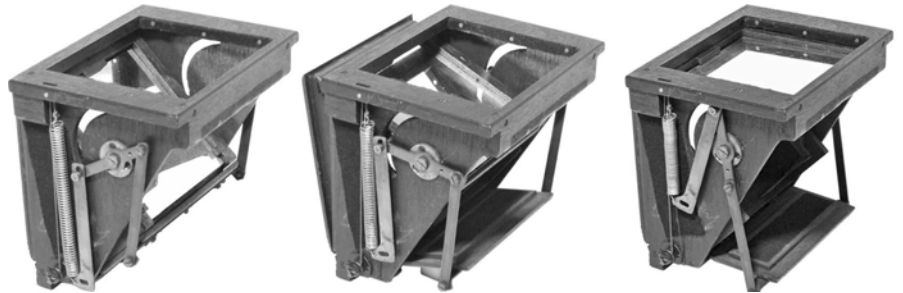
カーショー特許の後退しながら上昇するミラー。(左)ファインダーポジションで、ミラーと下から上がってきたパネルとで暗箱を作る。(中)後退しながらミラーが上がるころ。(右)露光中および露光後。
