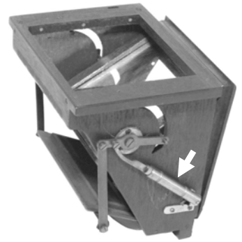
左側面から見たミラーボックス。ミラーが上昇中のポジションで、ミラーがピボットされる枠が後傾しているのがわかる。矢印はミラーショックを吸収するエアダンパー。
